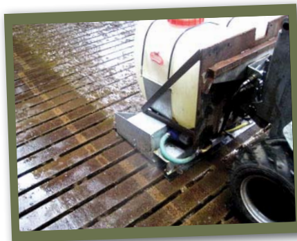
6. ábra Trágyarács tisztító-lemosó-szártó kistraktor-adapter munkája
