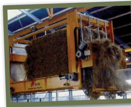
7. ábra Automatikus mennyiség-adagolóval felszerelt felsőpályás alomkiszóró berendezés
